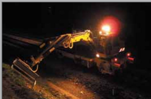
Decespugliatore e cippatrice cingolati progettati e realizzati da Tecnofer per interventi di taglio fuori dal binario
