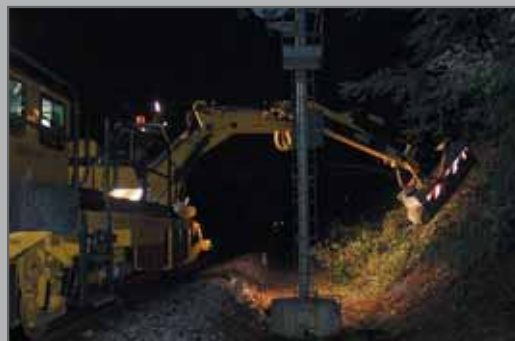
Decespugliatore e cippatrice cingolati progettati e realizzati da Tecnofer per interventi di taglio fuori dal binario
