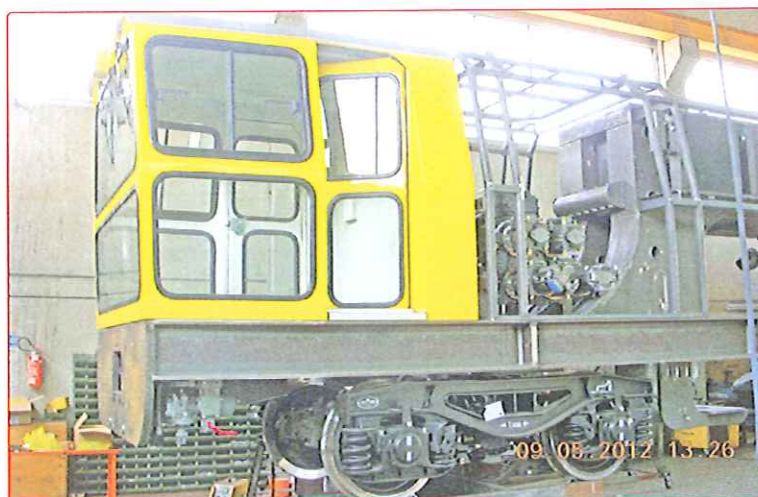
Fig. 16 - Il nuovo sistema di aspirazione SAI EVO in costruzione (particolare del rodiggio a carrelli)
