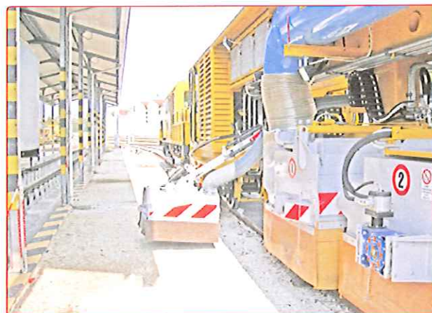
Fig. 12 - La spazzola ridotta ed autonoma per l'aspirazione dello sporco da altre superfici sia orizzontali che verticali presenti in galleria
