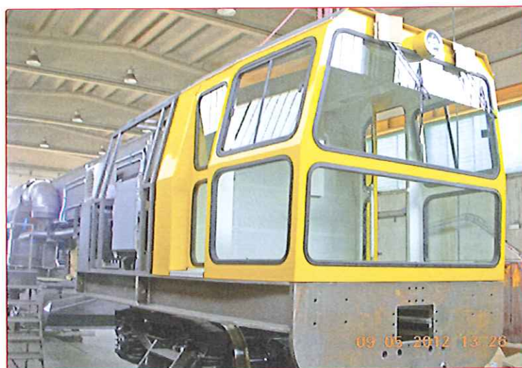
Fig. 17 - Il nuovo sistema di aspirazione SAI EVO in costruzione (profilo a sagoma ridotta rispetto al SAI 400, inscrivibile nelle nuove linee metropolitane automatiche)
