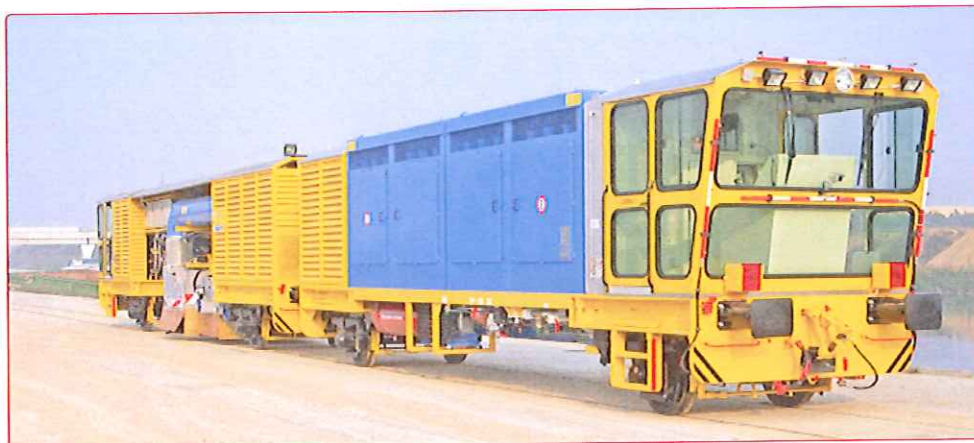
Fig. 13 - Un primo piano della seconda unità del treno Tecnofer SAI 400 dove è alloggiata la seconda cabina di guida
