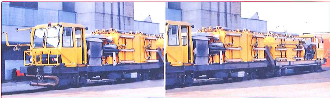
Fig. 7 - Il sistema di aspirazione "soffia/aspira" usato in ATM fino al 2010
