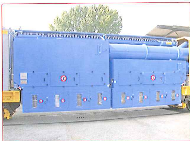
Fig. 14 - Batteria di filtri autopulenti ubicati nella seconda unità del mezzo Tecnofer SAI 400
