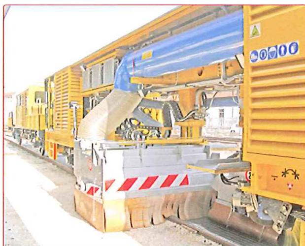
Fig. 11 - Le due spazzole rotanti in fase di lavoro
