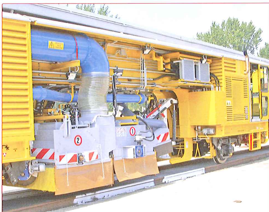
Fig. 10 - Le due "campane" contenenti le spazzole rotanti del mezzo Tecnofer SAI 400 attualmente in servizio in ATM
