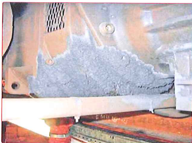
Fig. 4 - Il motore di un veicolo di trazione con incrostazioni
