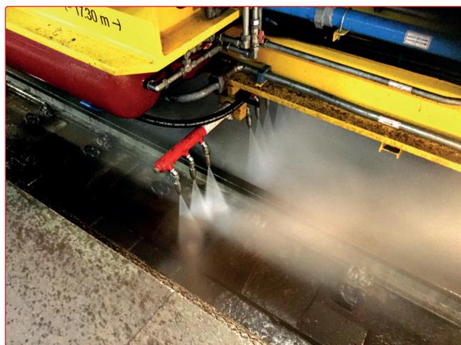
Fig. 5 - Sistema di lavaggio piattaforma e ballast ad altissima pressione
