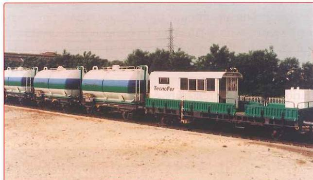
Fig. 20 - Treno diserbatore tipo OMART utilizzato da ditte appaltatrici
