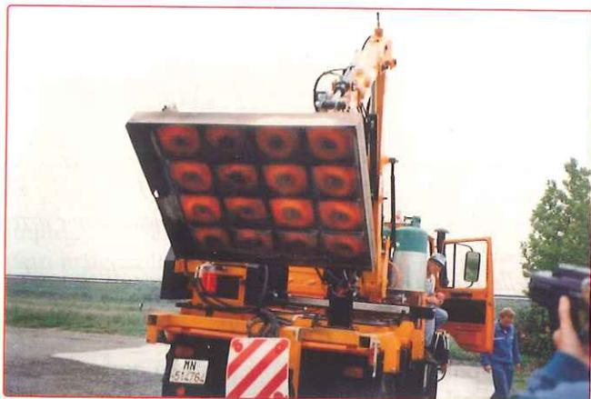
Fig. 5a - Attrezzatura pilota montata su mezzo strada/rotaia per il controllo della vegetazione con tecnica di pirodiserbo
